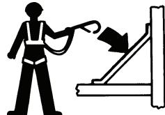
Personer i maskinen ska använda säkerhetsbälte eller sele och följa tillämplig, gällande lagstiftning. Fäst livlinan i den förankringspunkt som finns på plattformen.
