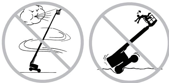
Var mycket försiktig och kör sakta med maskinen i det infällda läget över ojämnt underlag, skräp eller ras/rivningsmassor, instabilt eller halt väglag eller nära håligheter och branta sluttningar.
